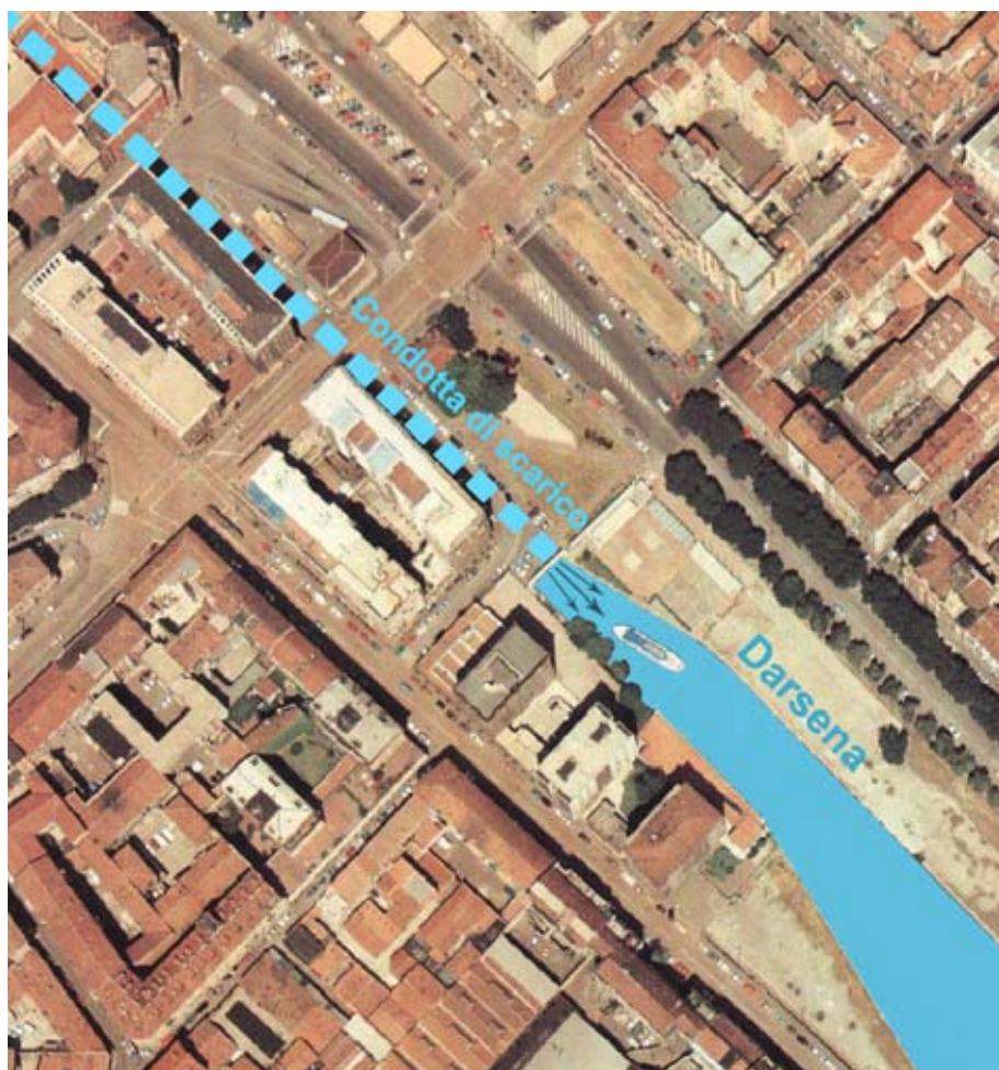
Particolare della condotta in sottosuolo per lo scarico dell'acqua prelevata da pozzi inattivi presenti nel Parco Solari per produrre energia e favorire il movimento dell'acqua in Darsena e alimentare il Naviglio di Pavia
